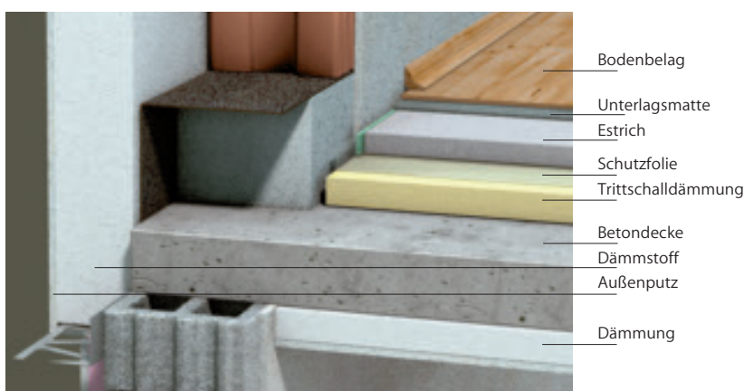
Abb 35 | Dämmung der Kellerdecke
