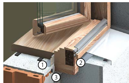
Abb. 21 | Dreiteiliger Baukörperanschluss / RAL Montage
