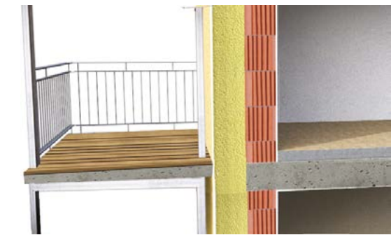
Abb. 25 | Vorgestellter Balkon – keine Wärmebrücke
