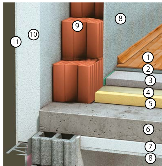
Abb. 18 | Dämmung der Kellerdecke
